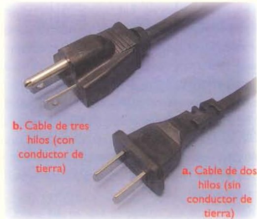
Figura 7.12 Aspecto físico y símbolos de los cables de potencia monofásicos para fuentes de alimentación
